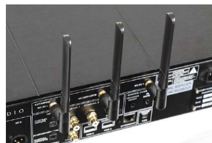
Trzy duże, panelowe anteny zapewniają wysoką stabilność i przepustowość połączenia.
